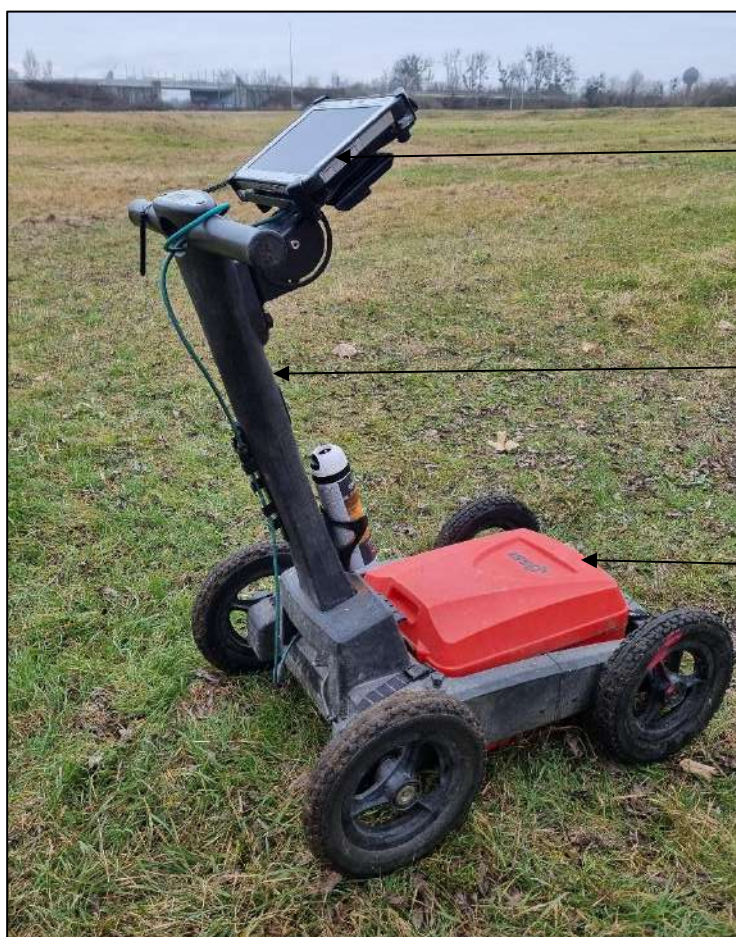
Photographie 1 – Antenne bi-fréquences 300/800 MHz et unité d'acquisition utilityScan DF montée sur chariot avec roue codeuse.
