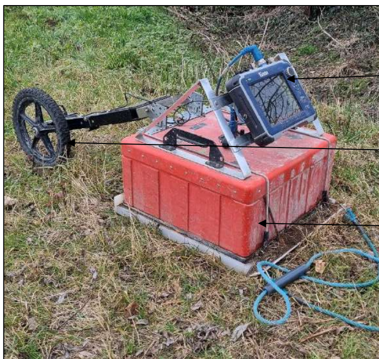
Photographie 2 – Antenne 200 MHz avec une roue codeuse et unité d'acquisition SIR 4000.
